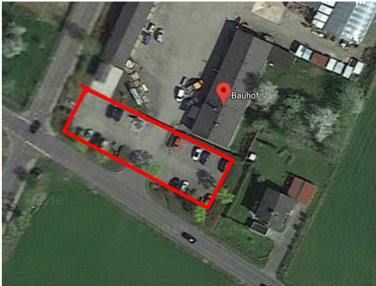
Abbildung 26. Empfohlener CarSharing-Stellplatz mit 5 Ladepunkten (3,7-11 kW) für vier E-Pkw und einem E-Transporter
